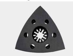
Piastra triangolare di ricambio per l'utilizzo dei fogli abrasivi velcrati di forma triangolare, con fori per l'aspirazione delle polveri. Misura da angolo ad angolo 93 mm. Attacco rapido Starlock.
