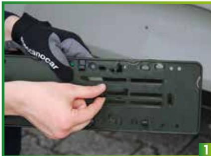
1) Inserimento vite nel supporto targa per fissaggio centrale
