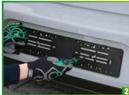
2) Fissaggio della targa mediante viti o rivetti al paraurti
