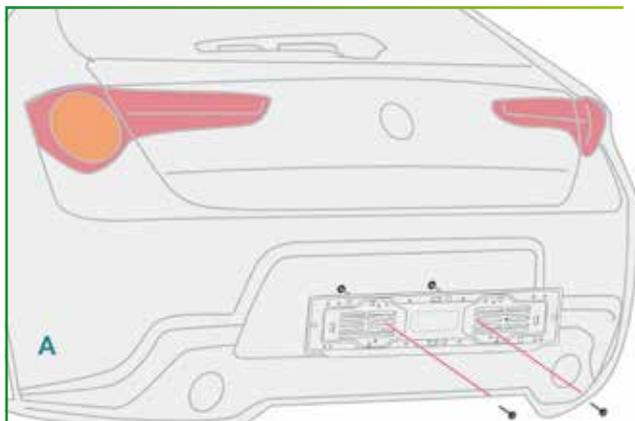
A - Fissare il supporto targa al telaio
