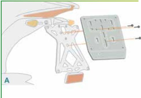
A - Fissaggio supporto targa al telaio
