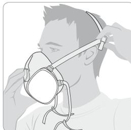
1. Posizionare il respiratore sulla bocca e sul naso e regolare la bardatura come illustrato.
