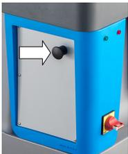
**Attenzione:** Spegner la pompa (tenendo premuto il fungo di avvio per 1 secondo) dopo aver terminato il ciclo di lavaggio. L'unità è comunque dotata di un timer elettronico che arresta la pompa automaticamente dopo 30 minuti dal suo avvio. Il timer può
