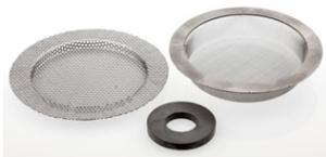
In dotazione due filtri e un filtro magnetico di serie: un filtro in lamiera d'acciaio perforata posto sul piano di lavoro che intercetta i materiali grossolani, al di sotto, un filtro fine (600 µ) in acciaio per materiali più sottili ed un filtro magnetico che trattiene le polveri e trucioli ferrosi. Si consiglia di lavare questi filtri e il magnete settimanalmente. A tal fine estrarre i filtri ed il magnete dalla lavapezzi e lavarli con acqua e liquido lavapezzi.
