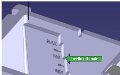
Controllare regolarmente il livello di riempimento per mezzo delle tacche posizionate sulla parete del contenitore poiché per dispersione ed evaporazione il liquido tende ad abbassarsi di livello. Se il liquido si dovesse trovare al di sotto del livello minimo la pompa e il dispositivo di riscaldamento si spengono automaticamente per ragioni di sicurezza. Rabboccare il liquido fino a raggiungere il livello ottimale di riempimento e avendo cura di non superare il livello massimo.
